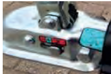
Abb. Farbanzeige der Auflaufbremse
