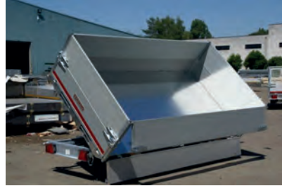
Abb. Oben scharnierverschlossene Bordwände
